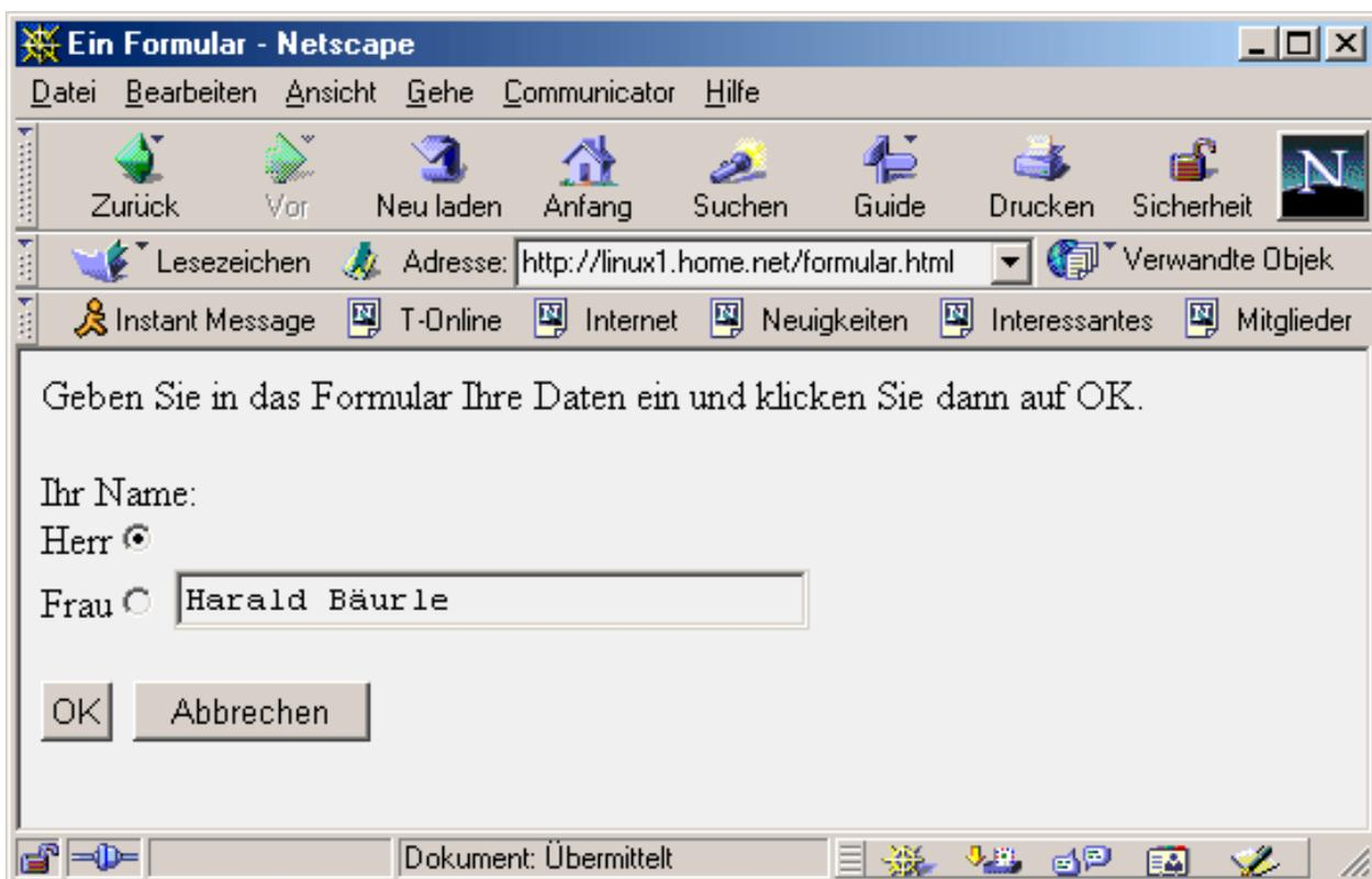
Der Klick auf den SUBMIT-Button *OK* führt zum Aufruf des CGI-Scriptes. Wie in der Befehlszeile des Browsers zu erkennen ist, werden die Formulareingaben bei der Methode *get* einfach an den CGI-Aufruf mit einem *?-Zeichen* angehängt. Dabei werden der Feldname und die im ausgefüllten Formular diesem Feld zugewiesene Eingabe als ein durch ein *=-Zeichen* getrenntes Wertepaar übermittelt. Die einzelnen Wertepaare werden wiederum durch ein *&-Zeichen* getrennt. Zusätzlich werden für die
